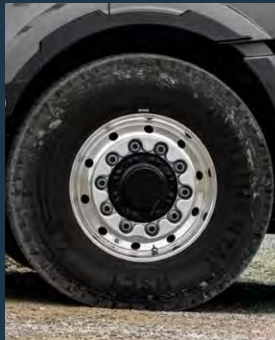
Vorderachse mit hydrostatischen Radnabenmotoren.
