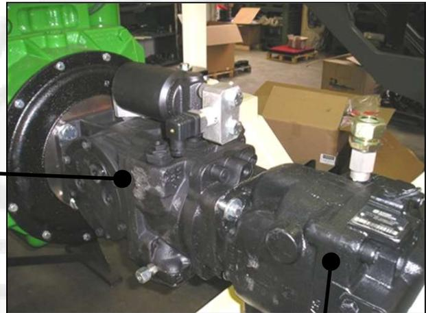
Ölpumpe mit verstellbarer Verdrängung, Propodertionalverteiler "Load Sensing", dem offenen hydraulischen Kreislauf gewidmet (für
