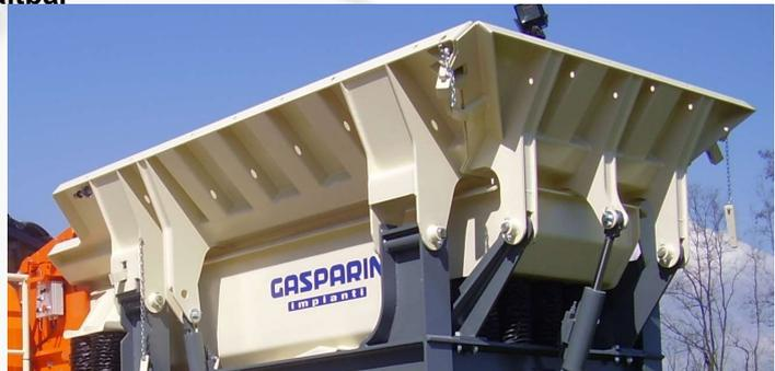
Die Zylinder der Faltwände sind geschützt im Rahmen untergebracht
