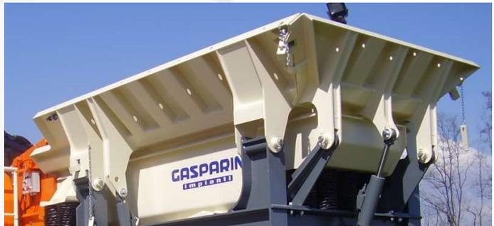
Die Zylinder der Faltwände sind geschützt im Rahmen untergebracht.
