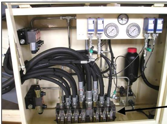
Propodertionalverteiler mit "Load Sensing" im offenen hydraulischen Kreislauf
