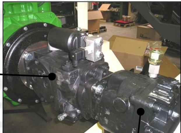
Ölpumpe mit verstellbarer Verdrängung Propodertionalverteiler "Load Sensing", dem offenen hydraulischen Kreislauf gewidmet (für die anderen Dienstprogramme).
