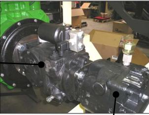
Ölpumpe mit verstellbarer Verdrängung Propodertionalverteiler "Load Sensing", dem offenen hydraulischen Kreislauf gewidmet (für die anderen Dienstprogramme)
