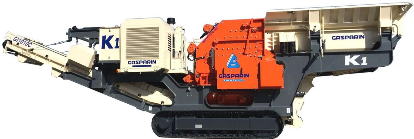
Der **GI CRUSHER K1** ist der neue Mobilbrecher in der Gasparin Omg Produktreihe; die Maschine ist mit Managementsystemen der neuesten Generation ausgestattet, einfach zu bedienen und umweltfreundlich. Entwederfen für alle Anwendungen, bei denen Feinmaterial benötigt werden, und auch für Recycling passend.
