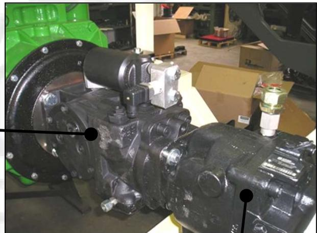
Ölpumpe mit verstellbarer Verdrängung
