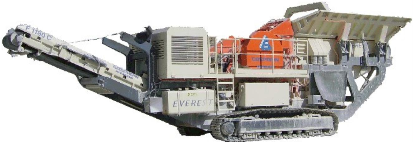
Das Modell **GI CRUSHER TRACK EVEREST** ist eine der größten Raupenbrecher in der Gasparin Omg Palette; die Maschine ist mit Managementsystemen der neuesten Generation ausgestattet, einfach zu bedienen und umweltfreundlich. Geeignet für jede Steinbrucharwendung (auch für sehr hartes Gestein), auch für Recyclinganwendungen.
