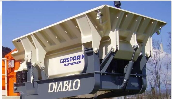
Die Zylinder der Faltwände sind geschützt im Rahmen untergebracht.
