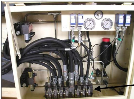
Proportionalverteiler mit "Load Sensing" im offenen hydraulischen Kreislauf
