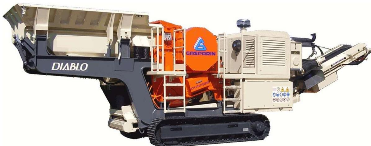
Das neue Modell CRUSHER TRACK DIABLO ist der modernste Raupenmobiler 28-Tonnen-Brecher auf dem Markt; die Maschine ist mit Managementsystemen der neuesten Generation ausgestattet, einfach zu bedienen und umweltfreundlich. Das HCS-System überprüft alle Maschinenkomponenten, d.h. maximale LEISTUNG in Bezug auf:
