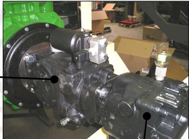
Ölpumpe mit verstellbarer Verdrängung
