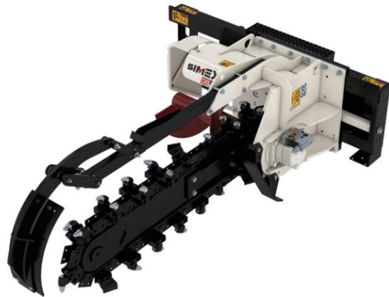
Die Kettenfräsen CHD für Baggerarme sind zum Ausfräsen von Gräben definierter Kontur in weichem Erdreich entwickelt. Die rechts liegende Förderschnecke und die Entleervorrichtung sorgen für saubere Gräben. Die Auflagekufen garantieren Stabilität unabhängig von der Grabentiefe. Die Kette ist mit Hacken für weiches Erdreich oder mit Hacken + Zähnen für gemischte Böden verfügbar.
