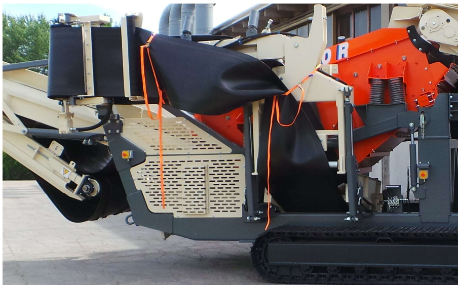
Hydraulische Faltung auf Maschinenseite für Transportkonfiguration
